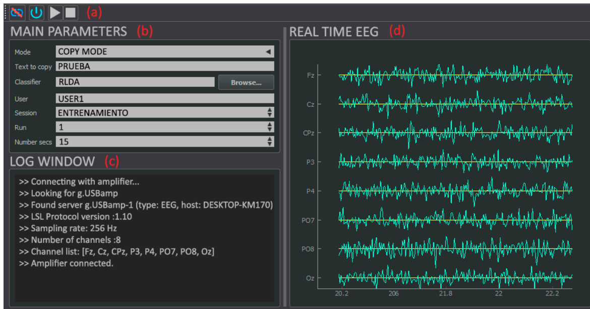
Figura 2: Panel principal de MEDUSA. (a) Botones de acción. (b) Panel de configuración principal. (c) Panel de información. (d) Representación del EEG en tiempo real.
