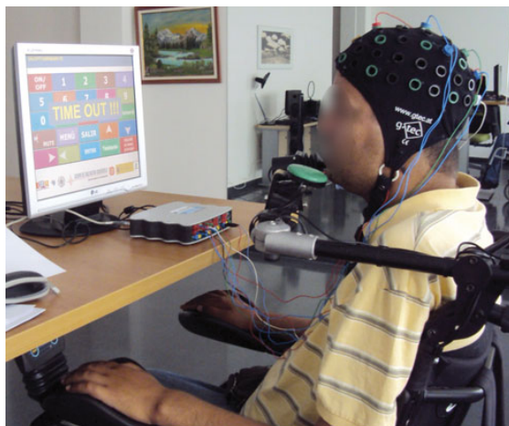
Usuario realizando pruebas con un sistema BCI. En la fotografía se puede observar el montaje de electrodos necesario para el registro de la actividad EEG, así como el amplificador de señales biomédicas empleado, que destaca por su pequeño tamaño.
